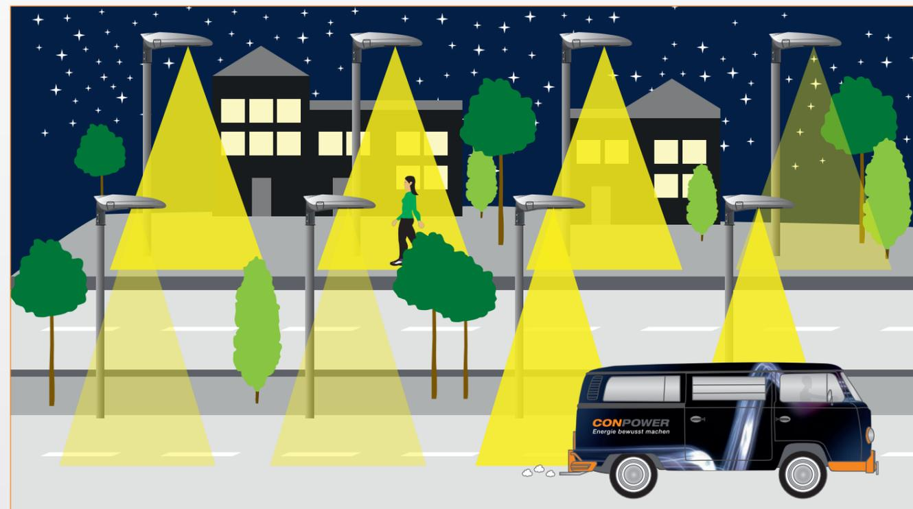
**FUNKNETZWERK:** Die Kommunikation zwischen den einzelnen Leuchten erfolgt in einem Mesh-Netzwerk. Daher kommuniziert jede Leuchte mit allen im Umfeld erreichbaren Leuchten und bildet damit ein Netzwerk.
